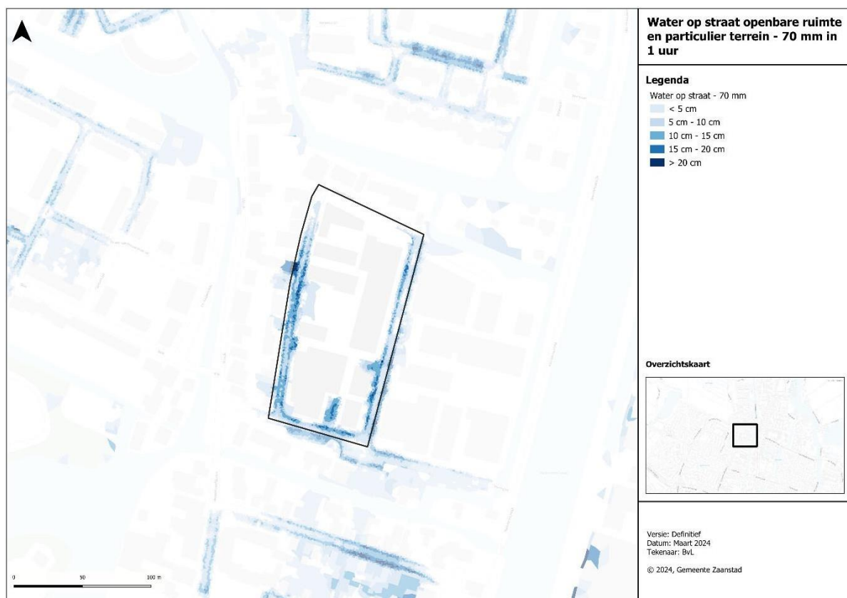
Afbeelding 10: Water op straat openbare ruimte en particulier terrein bij een bui van 70 mm in 1 uur.
